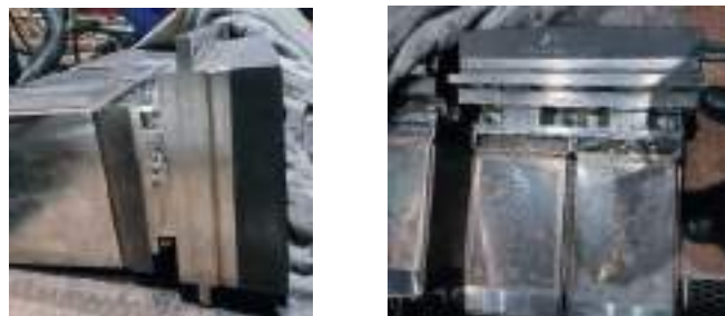
Рисунок 4 – Приёмные антенные модули прибора 1М с подстыкованными гермоконтейнерами аппаратуры предварительной обработки сигналов: (а) вид сбоку и (б) вид сверху
