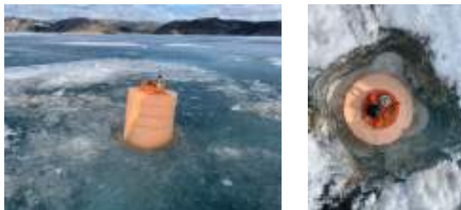
Рисунок 12 – Установка сейсмоприёмника в ледовом покрове озера Байкал
