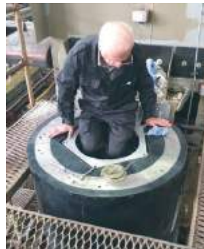
Рисунок 10 – А. М. Керимов залезает в прибор 1ЭЦ для подстыковки кабелей и проверки герметичности их соединения с антенными модулями
