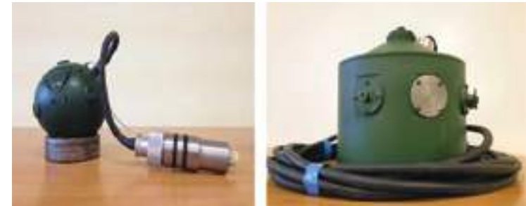
Рисунок 5 – Макеты пьезокерамических четырёхкомпонентных сейсмоприёмников
