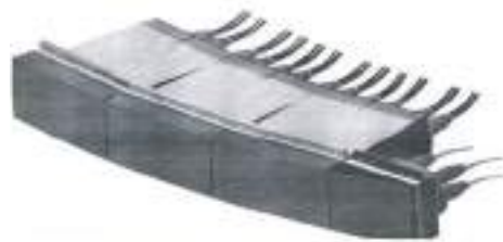
Рисунок 5 – Компьютерная модель прибора 1М в сборе (излучающий модуль справа)
