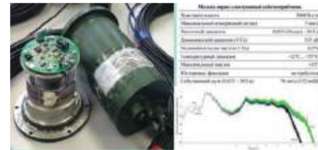
Рисунок 6 – Макет электронно-молекулярного сейсмоприёмника и его характеристики
