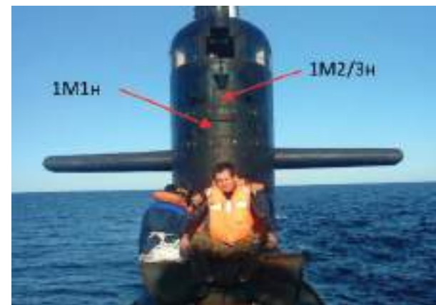
Рисунок 13 – Носовые приборы 1М1 и 1М2/3 на испытаниях ПЛ «Санкт-Петербург». На переднем плане испытатель Е. В. Данилов
