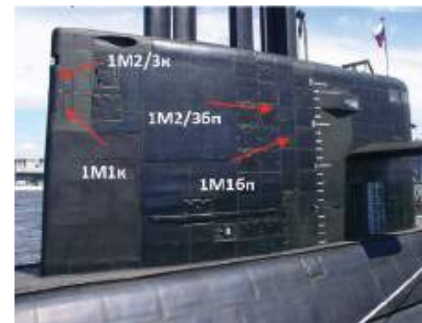
Рисунок 14 – Установленные кормовые и бортовые приборы 1М1 и 1М2/3 почти неотличимы от обшивки рубки
